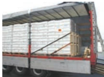
8.9.2.7. Paletes de sacos de grandes dimensões combinadas com amarração de topo num reboque com cortinas laterais ou num reboque com abertura lateral (reboques com cobertura rígida/não rígida ou reboque de lona)
