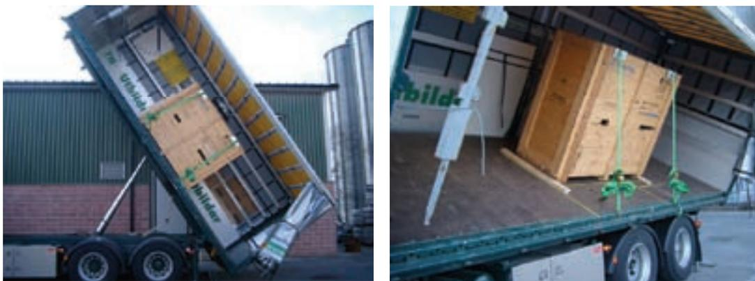
**Ensaio de eficácia do equipamento de fixação de um recuperador de calor para acelerações frontais e laterais.**
