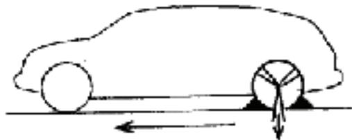
7.11.1.3. Se o veículo for transportado numa plataforma com um ângulo superior a  $10^\circ$  na direcção da frente do veículo de transporte, devem ser colocados dois calços à frente do par de rodas mais avançado e dois atrás do último par de rodas. As amarrações devem ser aplicadas às rodas dianteiras e traseiras.
