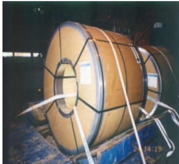
Cintas através e à volta da bobina
