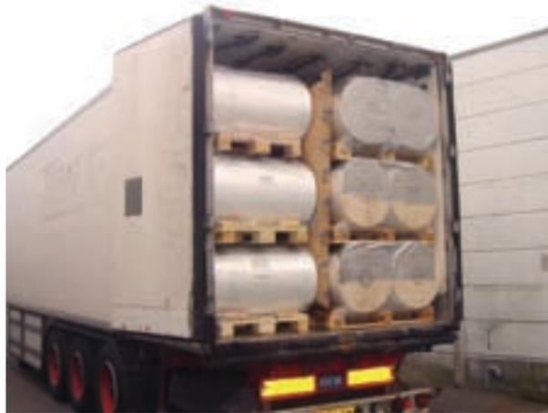
**Figura 16: Material de enchimento entre as camadas de carga**
