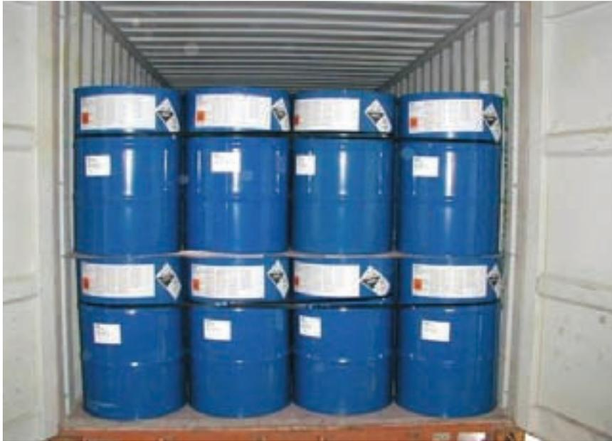
Tambores de aço, dispostos em pilhas duplas e acondicionados em bloco, fixados com cintas tensionáveis presas à estrutura do contentor.
