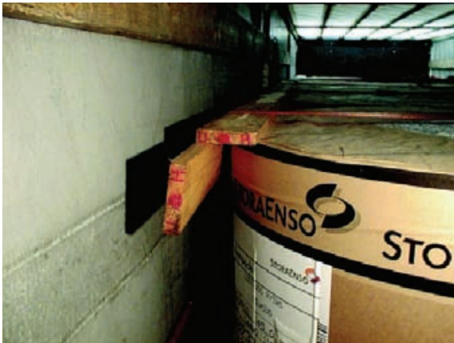
**Figura 51: Viga de bordadura feita de tábuas de madeira**
