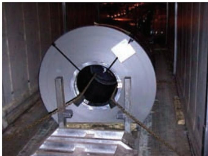
**Utilize uma viga (transversal) para evitar movimentos frontais. A viga (transversal) não deve amolgar a bobina. Para isso, proteja os pontos de contacto da viga com, por exemplo, tecidos sintéticos.**
