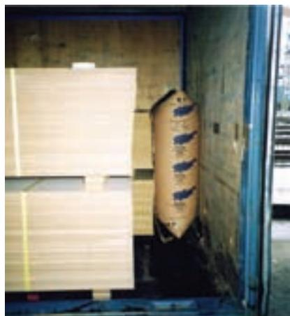
**Figura 17: Almofadas de ar num semi-reboque**
