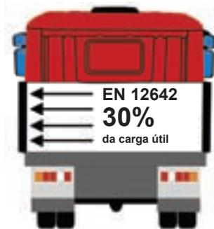
Figura 6: Requisitos de resistência dos painéis laterais
